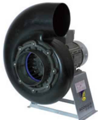
Центробежные вентиляторы одностороннего всасывания, изготовлены из антистатического пластика ATEX, для работы во взрывоопасной среде, оснащены взрывозащищенным двигателем CEE ExII3G Ex e или огнеупорным двигателем CEE ExII3G Ex d.
