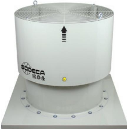
Крышные винтовые вытяжные вентиляторы с вертикальным выпуском воздуха, алюминиевым навесом от дождя, сертификацией АТЕХ и противозрывным (CEE ExII2G Ex e) или искробезопасным (CEE ExII2G Ex d, Ex tc или Ex tb) двигателем для работы во взрывоопасных средах, содержащих пыль или газ.
