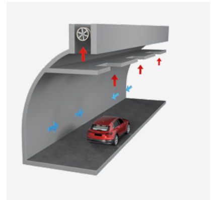
LÜFTUNG IN HALBQUERRICHTUNG
