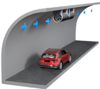
LÜFTUNG IN LÄNGSRICHTUNG
